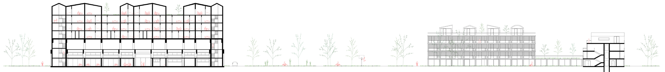
Schnitt durch Aufstockung der Halle
