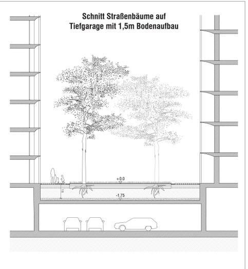
Schnitt Straßenbäume auf Tiefgarage mit 1,5m Bodenaufbau
