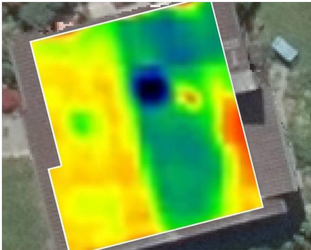
Das Beispielbild zeigt unterschiedliche Schwachstellen in der Wärmedämmung eines Einfamilienhauses. Durch eine energetische Sanierung lässt sich wirksam Energie und langfristig auch Geld sparen. Dabei ist wichtig, nicht nur das Dach auf Energiesparpotenziale zu prüfen, sondern das gesamte Gebäude in den Fokus zu nehmen.
