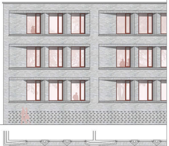
Fassadenansicht Erweiterung Klassenräume Nord/Südseite 1:30
