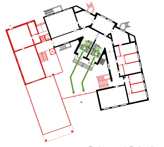
Fluchweg nach Fertigstellung
