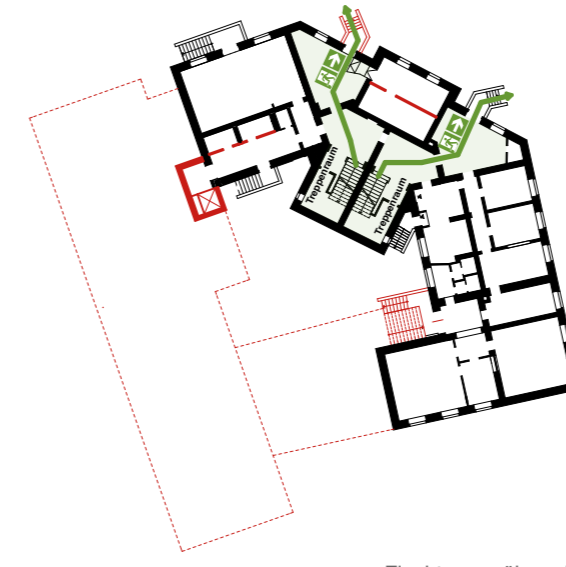
Fluchweg während Bauzeit
