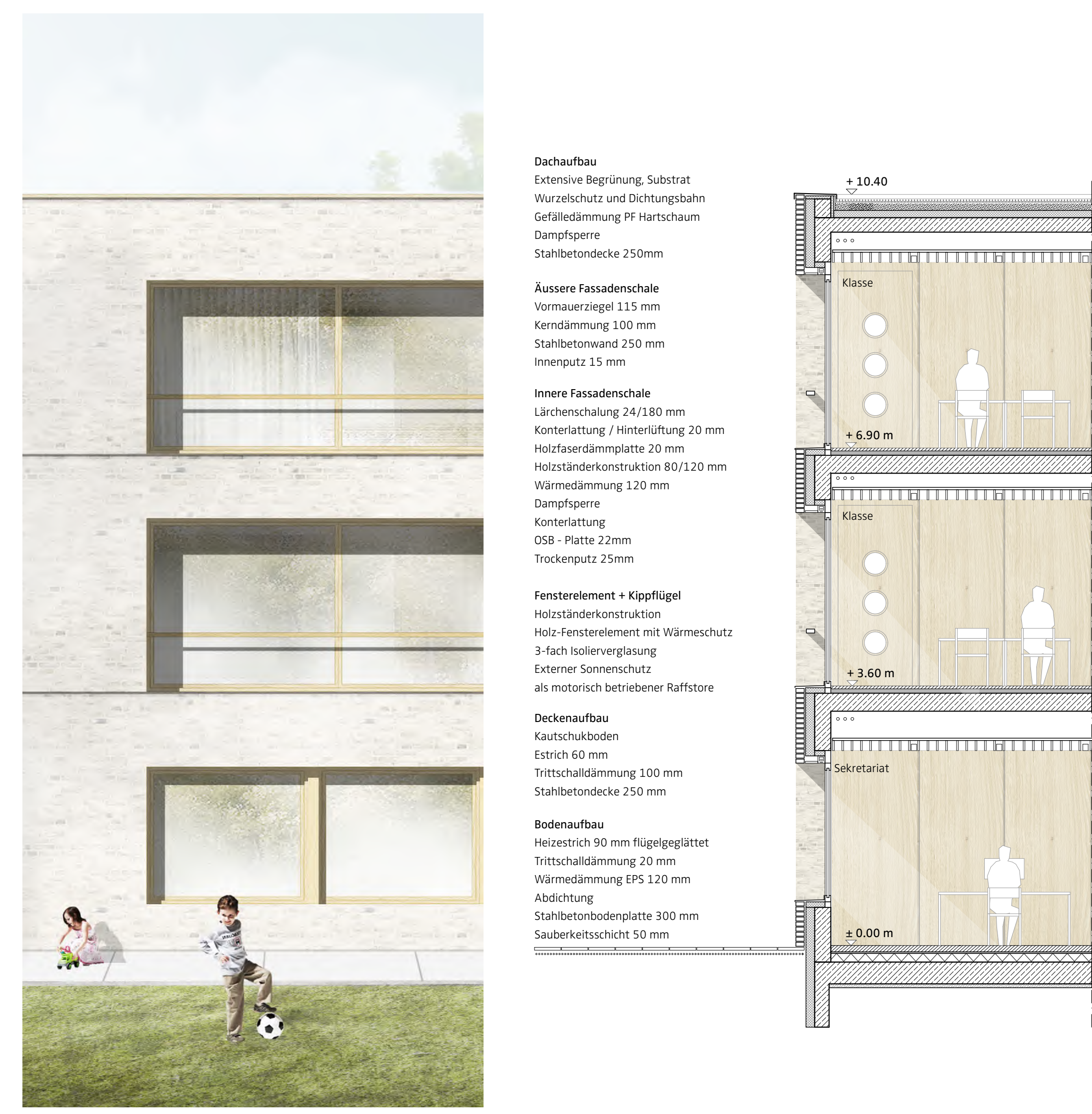
Detail Fassadenansicht M 1:50
