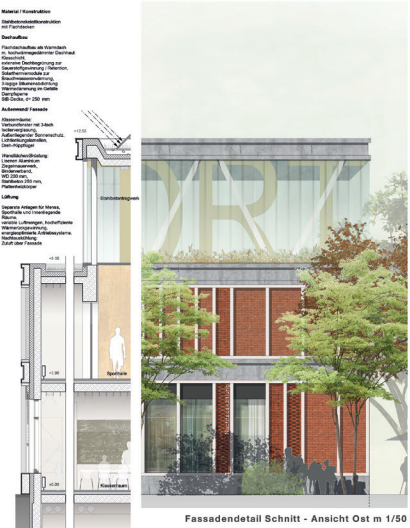
Fassadendetail Schnitt - Ansicht Ost m 1/50
