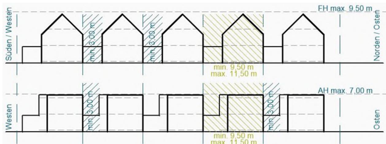
*Abb. 1 Darstellung der abweichenden Bauweise (blaue Strichlinie und Schraffur) und Breite der Baugrundstücke (grüne Schraffur) für Gebäude mit Sattel- oder Flachdach – ohne Maßstab*
