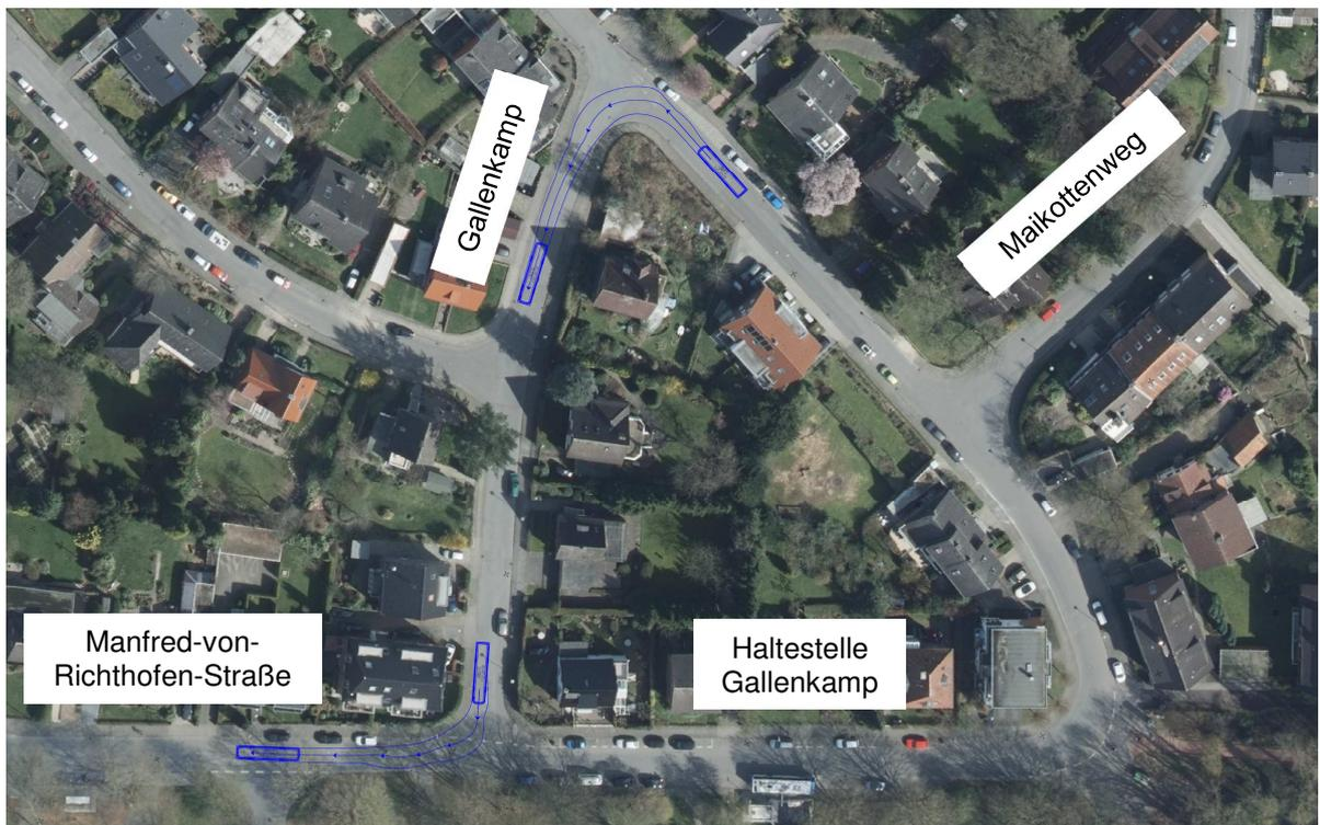
**Abbildung 12 - Ersteinschätzung Schleppkurvenprüfung Wenderoute Linie 14**
