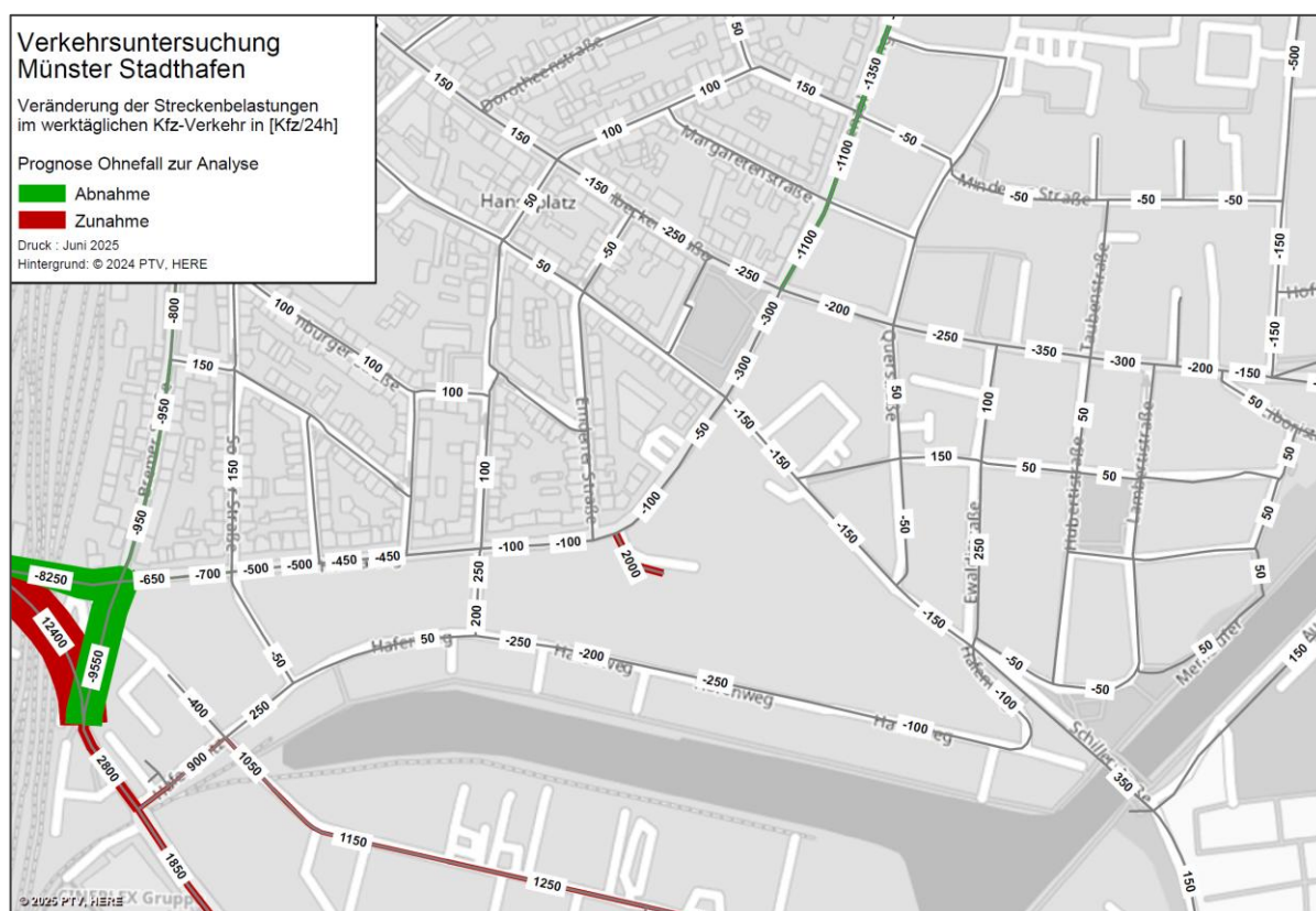
Abbildung 3-2: Belastungsveränderung zwischen dem Prognose Ohnefall und dem Analysefall (Quelle Hintergrundkarte: © PTV, HERE)
