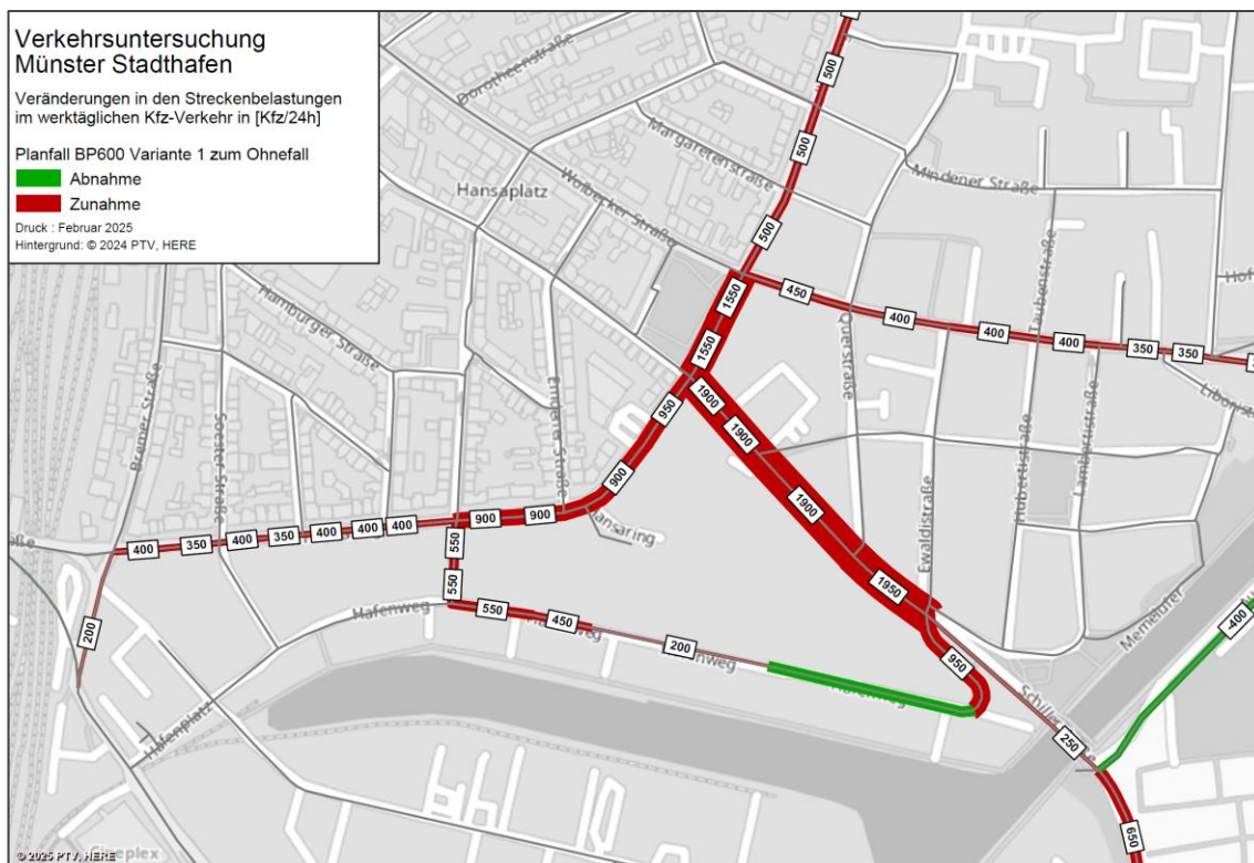
Abbildung 3-5: Belastungsveränderung zwischen dem Planfall Variante 1 und dem Ohnefall (Quelle Hintergrundkarte: © PTV, HERE)
