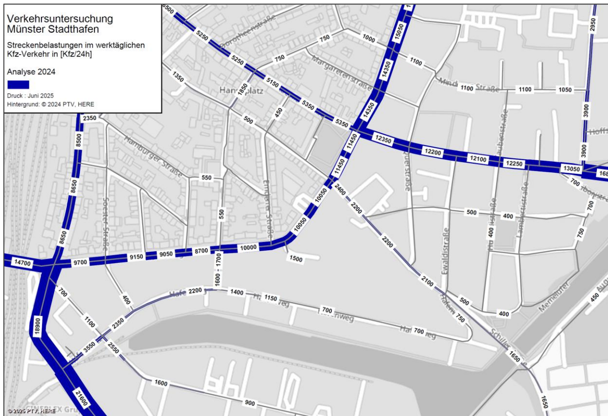
Abbildung 2-3: Streckenbelastungen im Analysefall ohne Baustelle Bremer Straße (Quelle Hintergrundkarte: © PTV, HERE)
