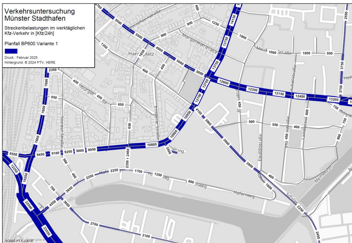
Abbildung 3-4: Streckenbelastungen im Planfall BP 600 Variante 1 (gemäß BP401)
