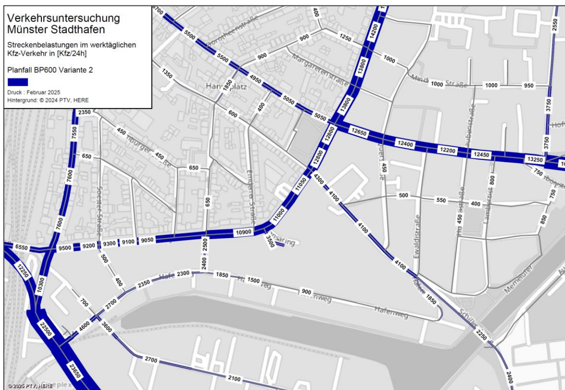
Abbildung 3-6: Streckenbelastungen im Planfall BP 600 Variante 2
