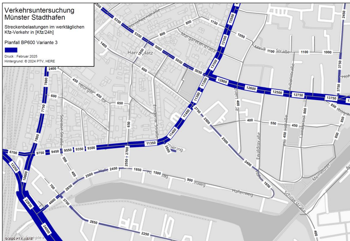
Abbildung 3-8: Streckenbelastungen im Planfall BP 600 Variante 3 (Quelle Hintergrundkarten: © PTV, HERE)
