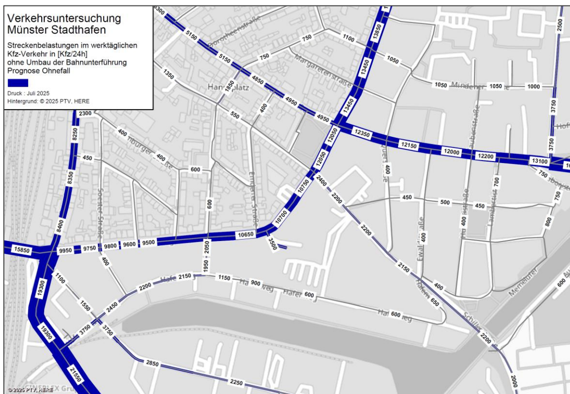
Abbildung 3-11: Streckenbelastungen im Prognose Ohnefall ohne Umbau der Bahnunterführungen
