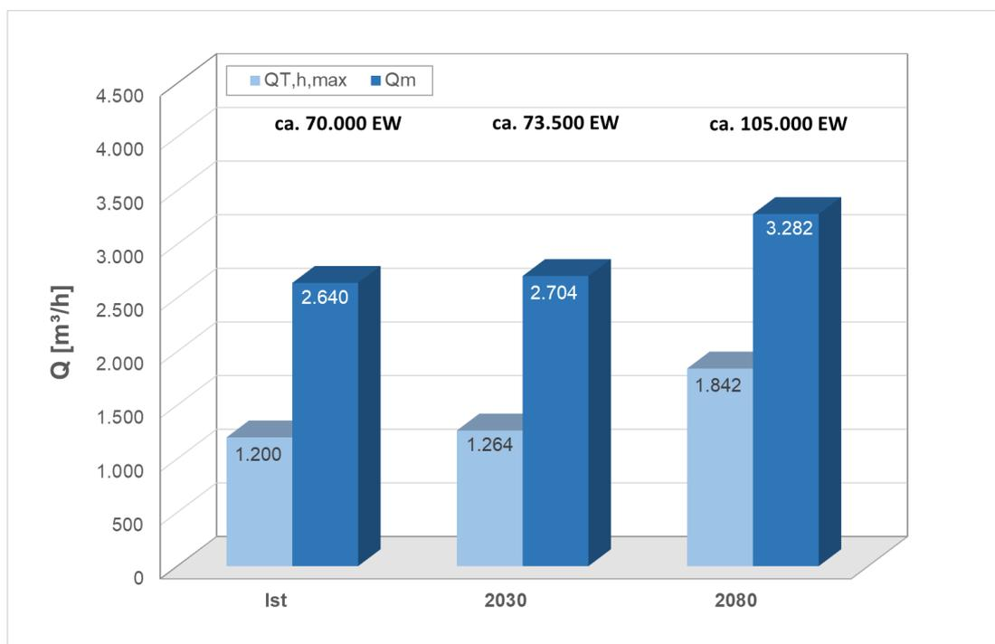
Abbildung 7-3: Bemessungsabwassermengen Zulauf Kläranlage Hilstrup
