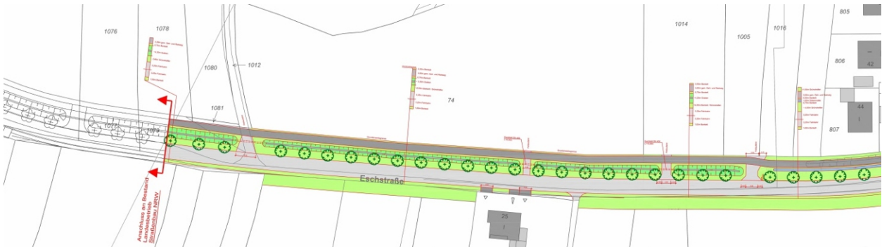
Abb. 6: Auszug Verkehrstechnischer Entwurf – Abschnitt zwischen Ortsumgehung Wolbeck und Anfang Bebauung
