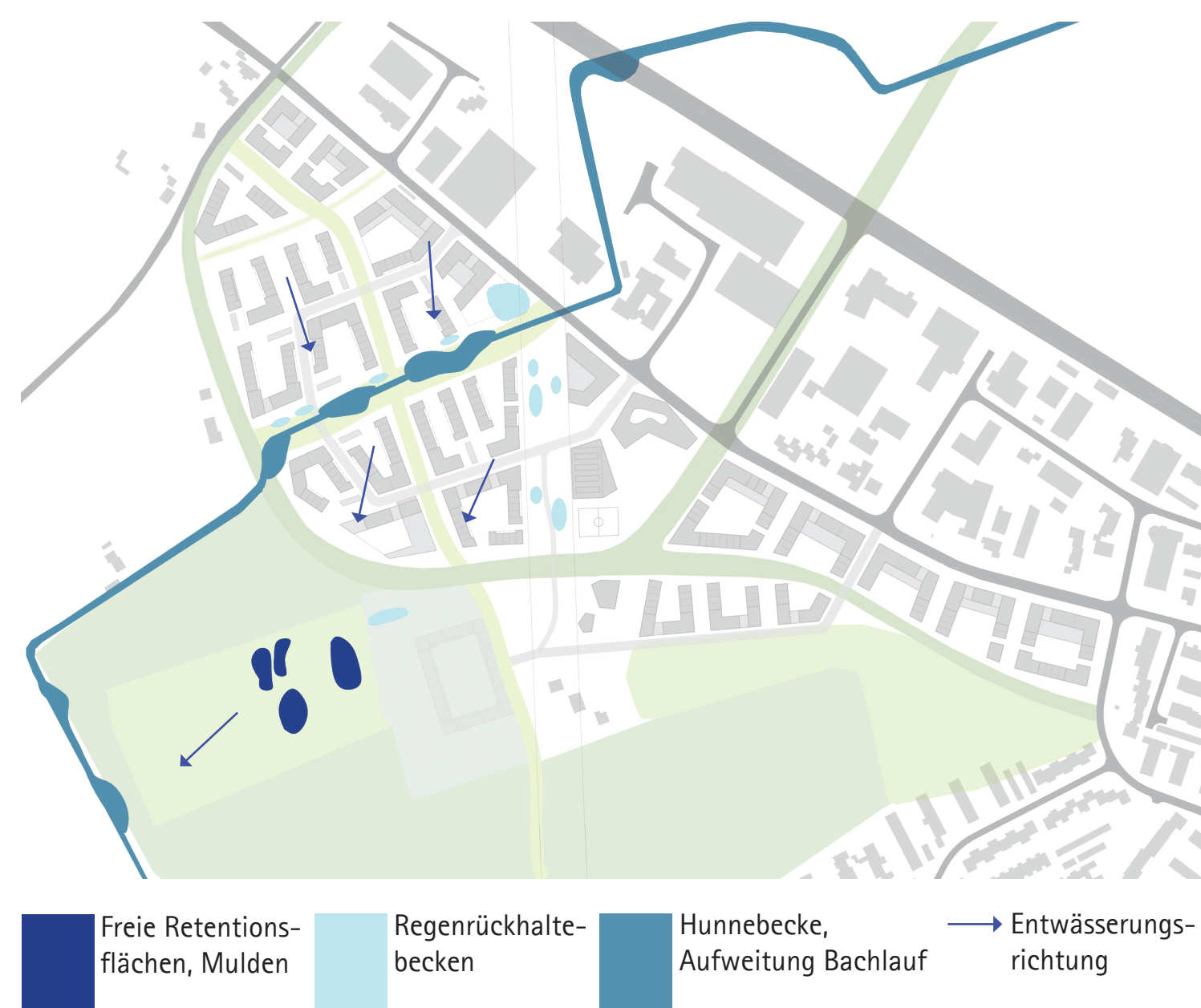
Entwässerungskonzept I o.M.
