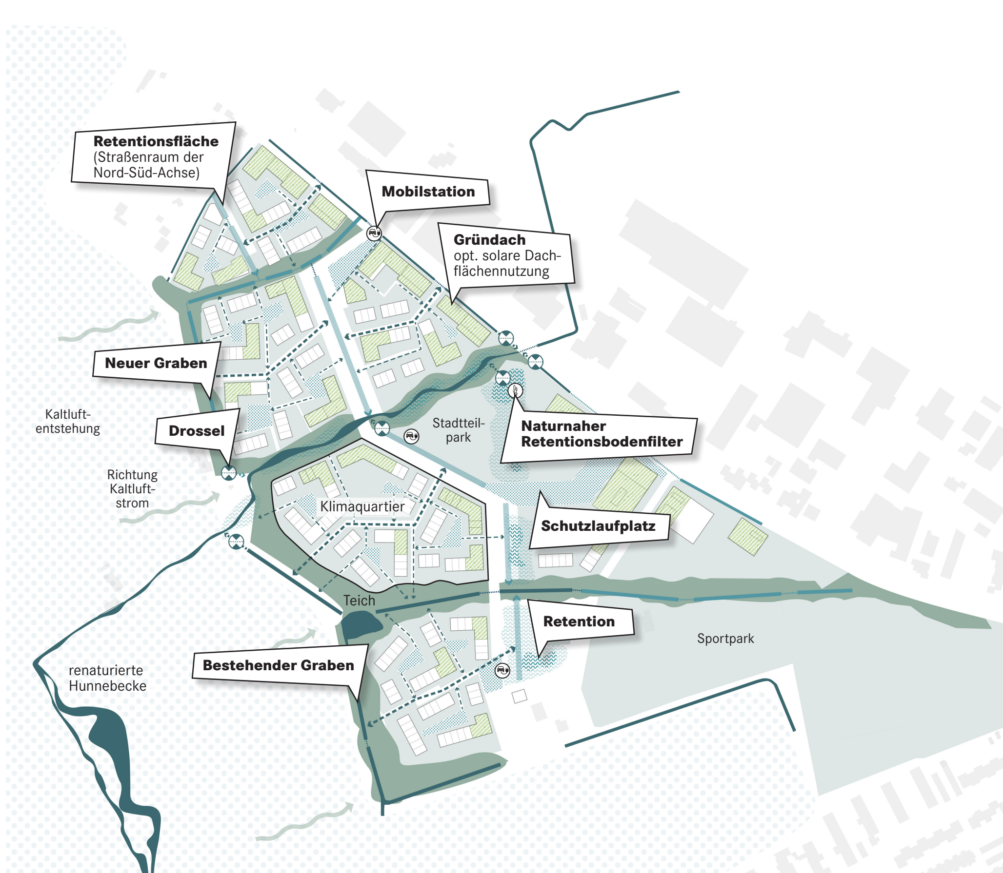
Klimaanpassung und Klimaschutz Entwässerungskonzept mit ergänzenden Aussagen
