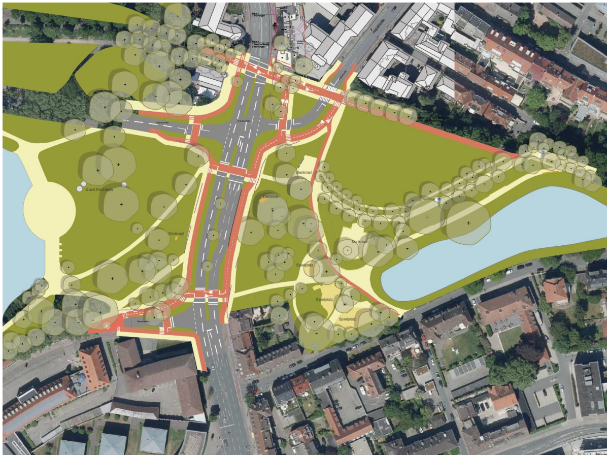
Abbildung 29: Rückbau der Weseler Straße auf 5 Fahrspuren
