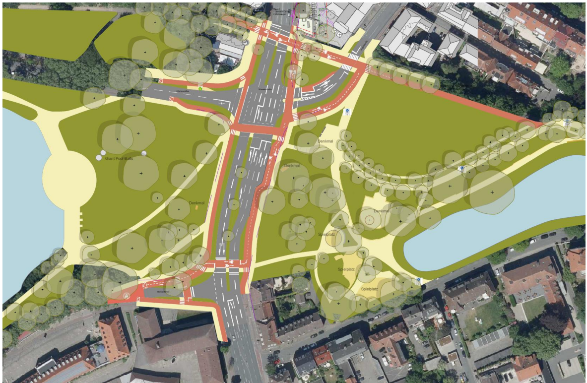
Abbildung 30: Rückbau der Weseler Straße auf 6 Fahrspuren
