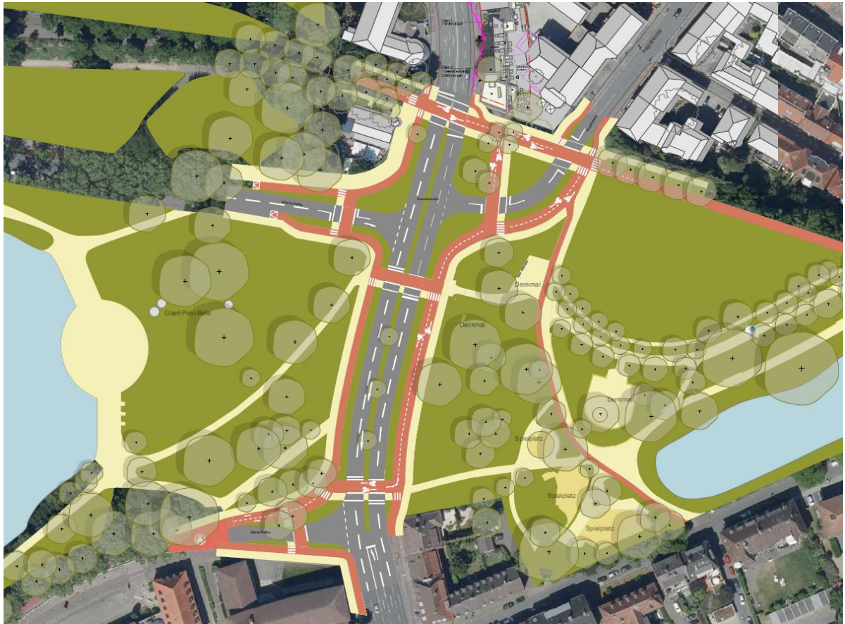
Abbildung 27: Rückbau der Weseler Straße auf 4 Fahrspuren
