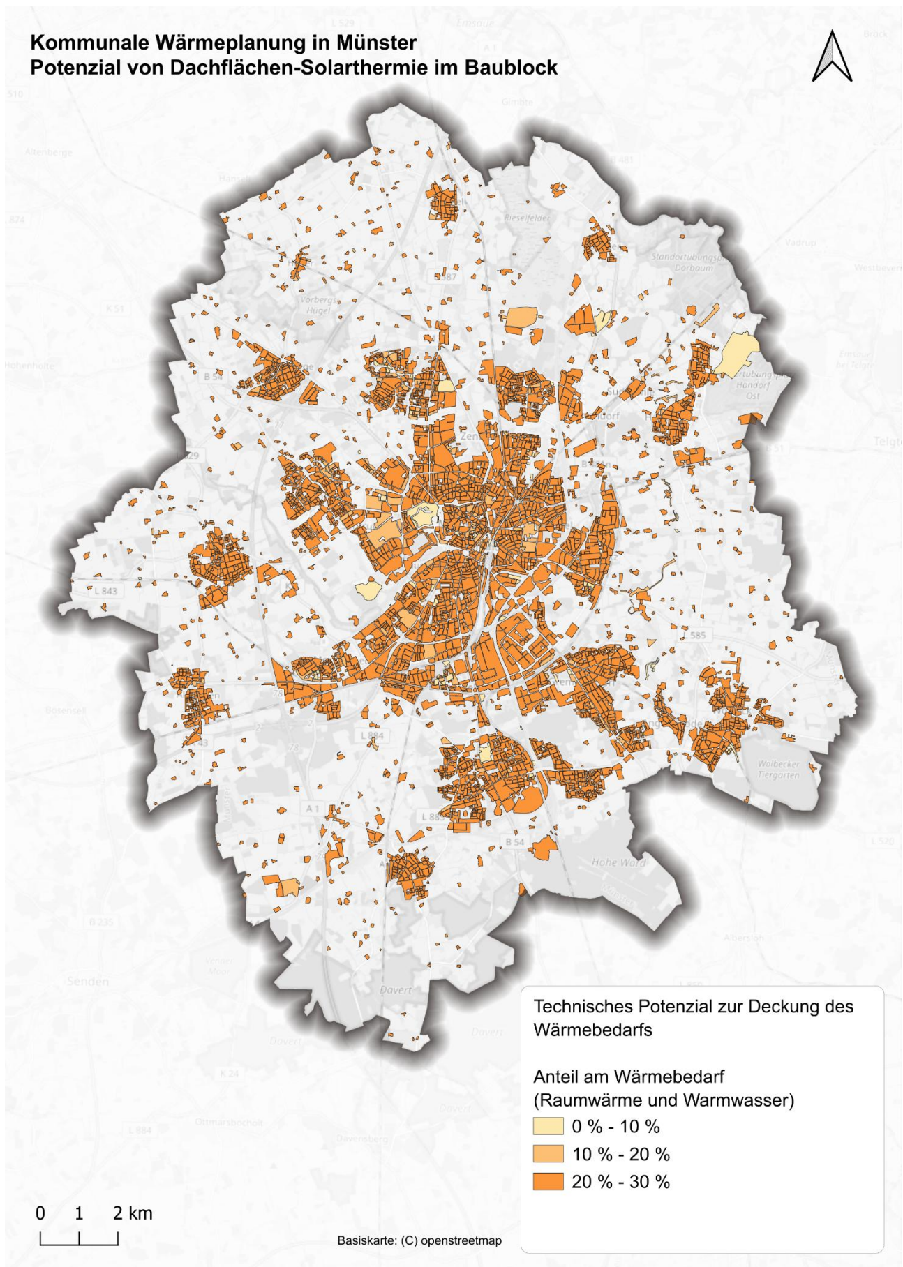
Abbildung 55: Technisches Potenzial von Dachflächen-Solarthermie, Darstellung auf Baublockebene
