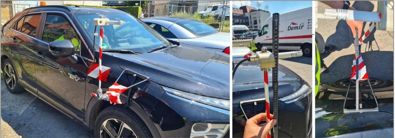
Abbildung 39: Anbringung des Temperatursensors für die Messfahrt am PKW (links), Höhe über Grund (Mitte) und seitlicher Abstand vom Fahrzeug (rechts).
