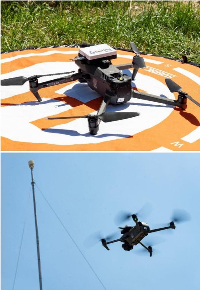
Abbildung 41: DJI Mavic 3T in Nahansicht mit der Radio-sonde iMet-XQ2 (oben) und im Aufstieg an der Messstation (unten) (Bildquellen: GEO-NET).
