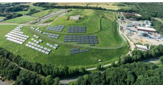
Die größte PV-Anlage in Münster auf der Zentraldeponie II in Coerde. Auf rund 8.000 Quadratmetern nutzen über 4.500 Photovoltaik-Module die Energie der Sonne zur Stromerzeugung und erreichen in der Spitze eine Leistung von 1.142 Kilowatt Peak (kWp). Die durchschnittliche Energieerzeugung jährlich beträgt eine Million Kilowattstunden (kWh). Das entspricht dem Verbrauch von über 280 Haushalten mit einem jährlichen Durchschnittsverbrauch von 3.500 kWh.
