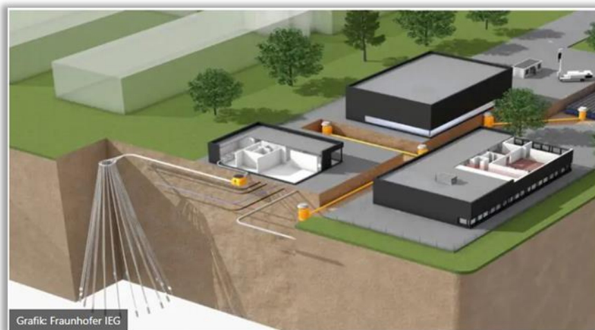
Abbildung 111: Prinzipdarstellung Geostar-Erdsonden (Fraunhofer IEG)
